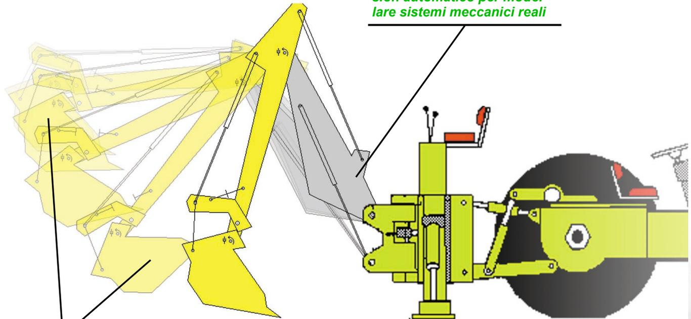
Consente di seguire il movimento di un oggetto con specifici parametri di simulazione
